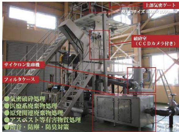
写真2. 高気密タイプ破碎機の構成
